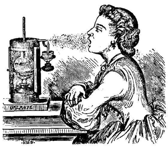
Cet appareil se compose d'un cylindre de métal, à l'intérieur duquel est placée une lampe à alcool qui supporte une chaudière de cristal. Cette chaudière est munie d'un goulot, dans lequel est placé un bouchon de caoutchouc, percé de deux trous : dans l'un passe un tube de cristal, par lequel
